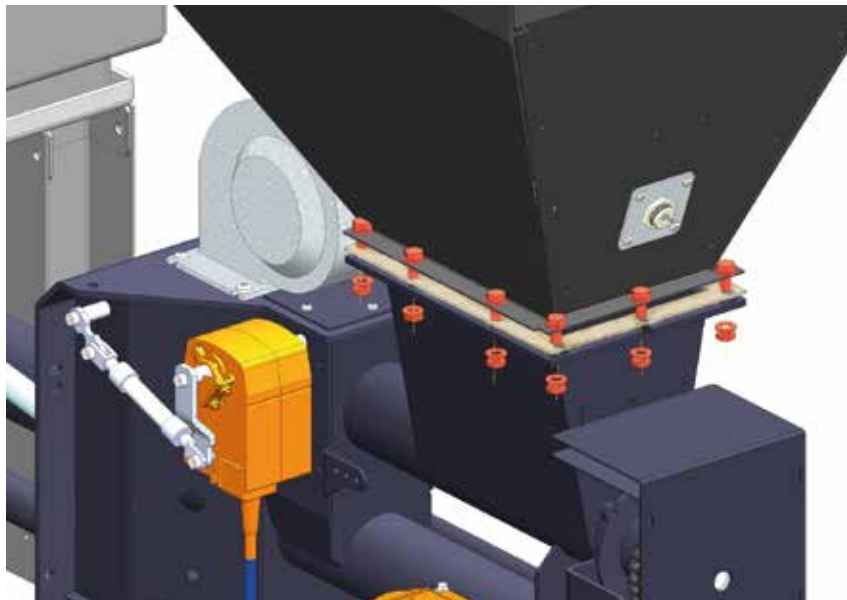
Fissaggio del serbatoio alla flangia del bruciatore.
