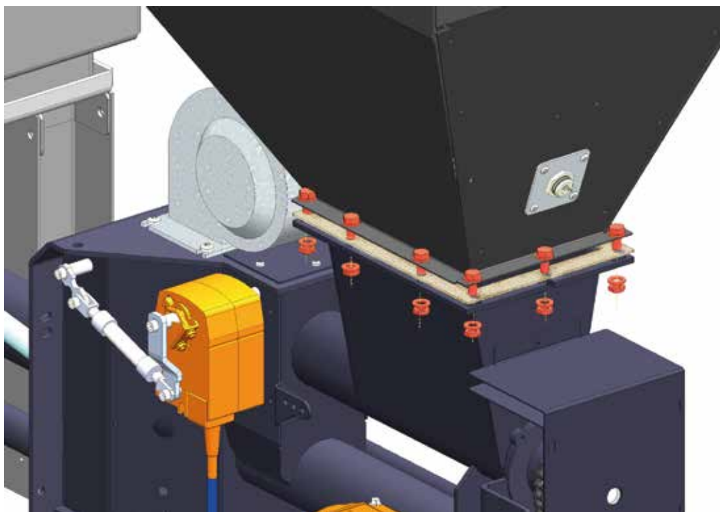
Fissaggio del serbatoio alla flangia del bruciatore.
